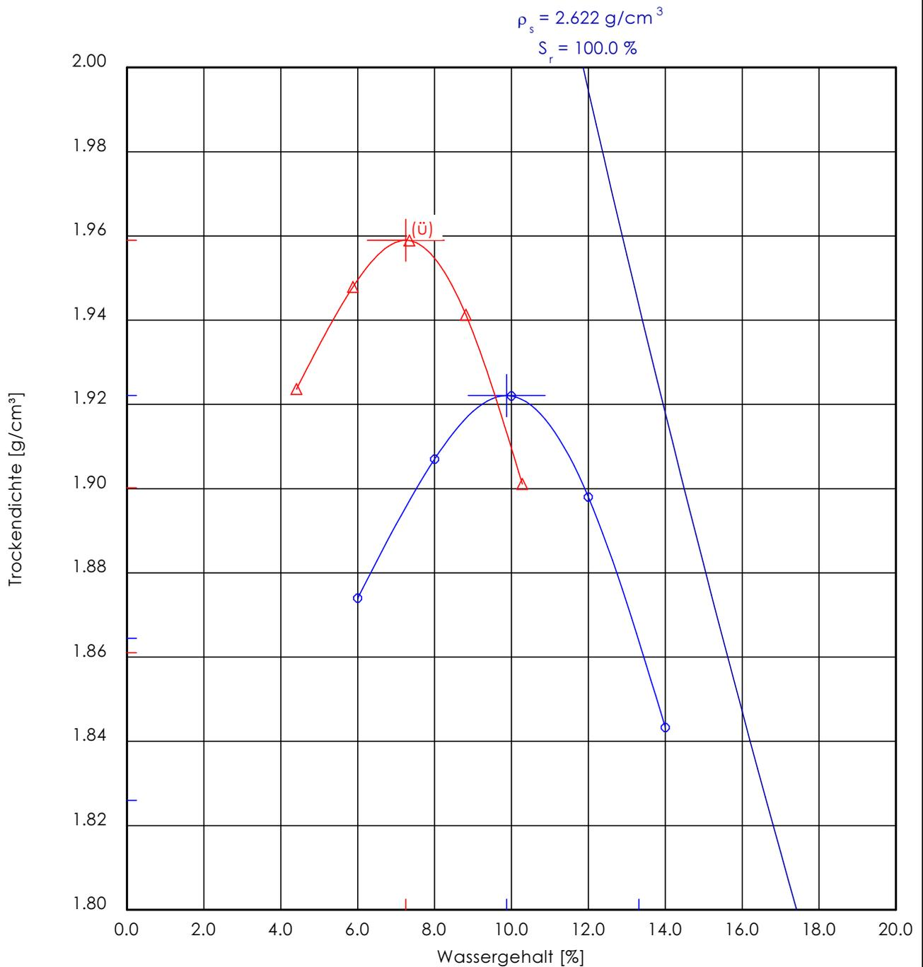
100 % der Proctordichte  $\rho_{Pr} = 1.922 \text{ g/cm}^3$
